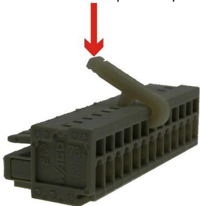
V případě ztráty háčku je možné použít i tenký plochý 2mm šroubovák, který se zasune do horního otvoru. Mírným tlakem směrem dovnitř dojde k odklopení zámku pro kabeláž. V případě malého odklopení je možné mírným nadzvednutím šroubováku zámek odklopit více.
