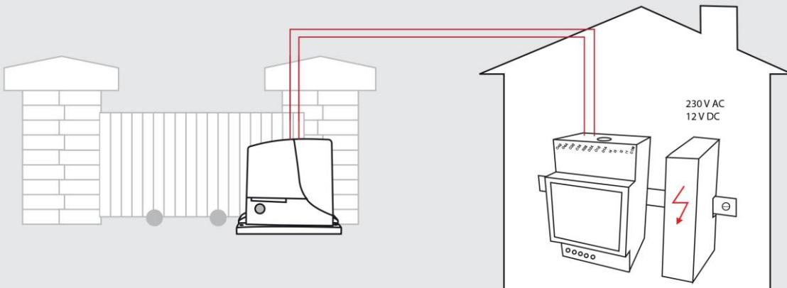
Zařízení je určeno pro vnitřní montáž nebo montáž do vodotěsného plastového rozvaděče.
